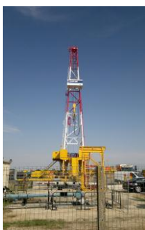
Derrick pour la géothermie, près de l'hôpital de Coulommiers
